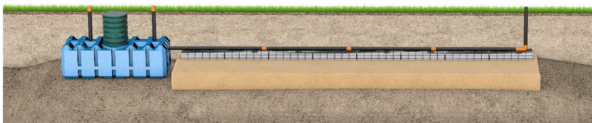
Figur 1. Horisontell infiltration med in-drän moduler.
